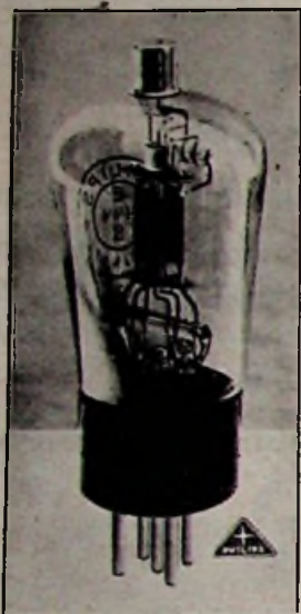
Fig. 2. Ongemetalliseerd laboratoriummodel van de Philips „Binode” E 444 S. Uitvoering als triode. Bovenin ziet met het diodegedeelte. (No. 04449).
